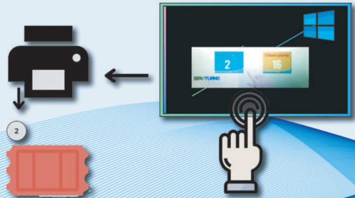
Este sistema comprende un proceso de asignación de turnos, con un dispensador de tickets que son tomados por los usuarios, así como pantallas LED para la visualización de turno que varía en cuanto a diseño, formato y tipo de iluminación. Incorpora, según las necesidades de la empresa, terminales de llamado para que la persona encargada de la atención a los clientes haga fluir los turnos asignados.
